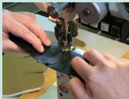
Sešívání svršku na sloupovém šicím stroji.
