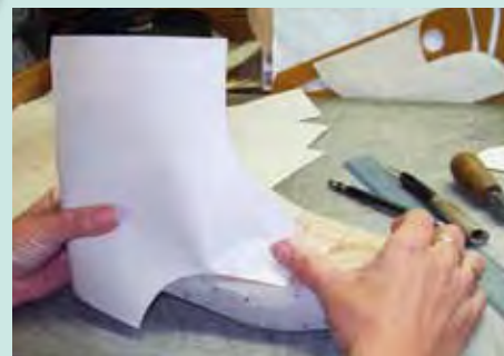
Výroba papírových šablon dle upraveného kopyta.
