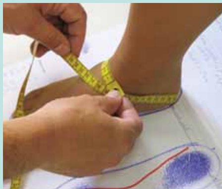
Snímání měrných podkladů pro výrobu obuvi.
