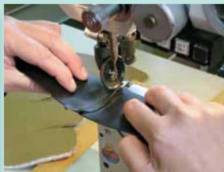
Sešívání svršku na sloupovém šicím stroji.
