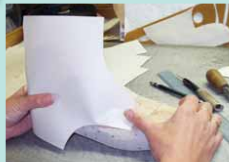
Výroba papírových šablon dle upraveného kopyta.
